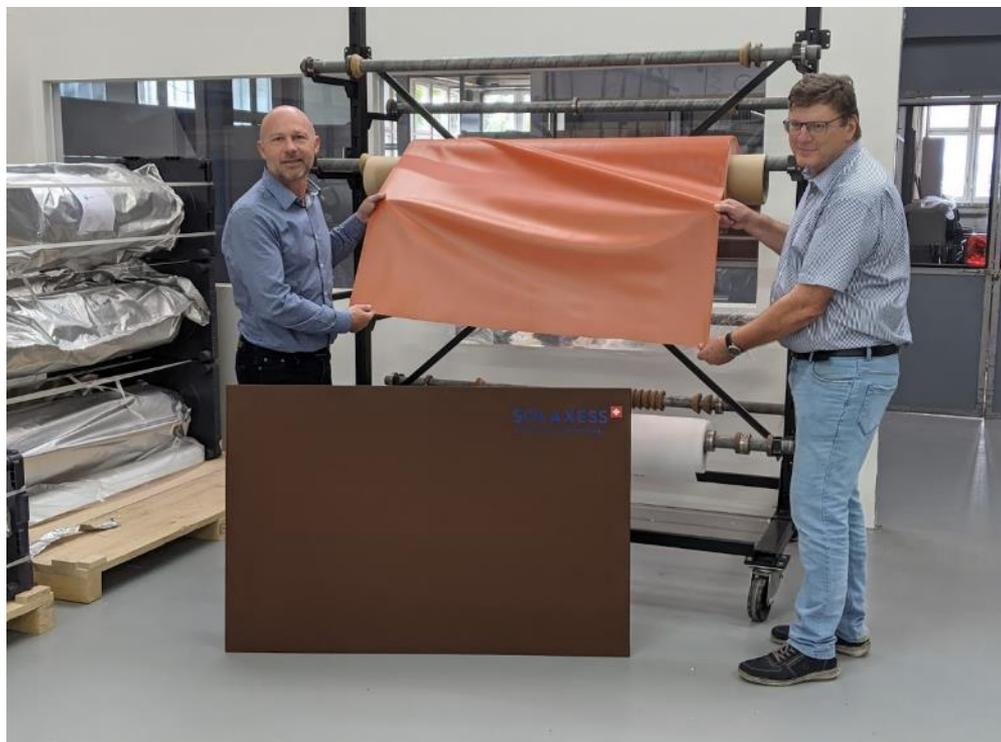
Le film inséré à l'intérieur du panneau pour masquer les cellules passe de orange à brun
